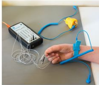
Abb. 2: Antistatische Unterlage und Erdungsarmband, die gemeinsam über einen speziellen Stecker mit der Erde des Haushalts-Stromnetzes verbunden werden.
